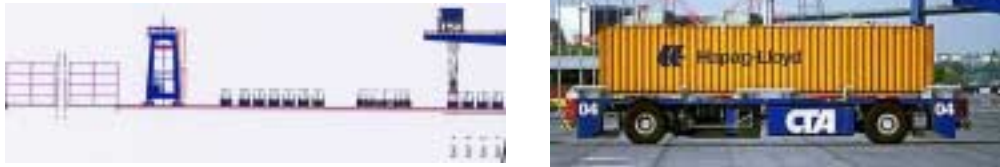
Abbildung 4: AGV zwischen Containerbrücke und Containerlager 6
